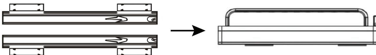
В выдвинутом положении штанги, нажмите на фиксирующие клипсы с 2-ух сторон и снимите ответную часть штанги с направляющей.
